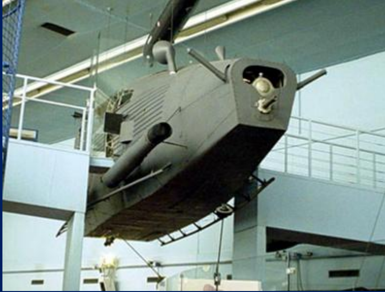
Exterior de la góndola motriz de un dirigible alemán en el que se observa el eje de la hélice, los tubos de escape enmascarados y los asideros para facilitar la maniobra en tierra. Fuente: A. Pérez
